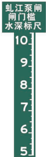
图 87 闸门槛水深标尺(代码 1002)示例
